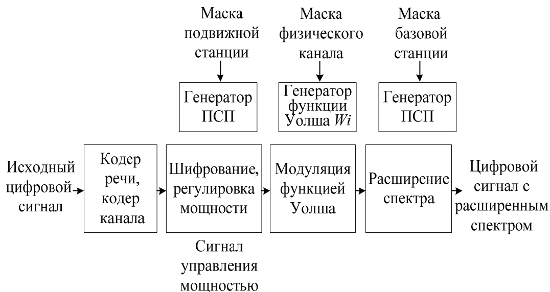
Рис. 35. Схема обработки сигналов в передающем тракте базовой станции
